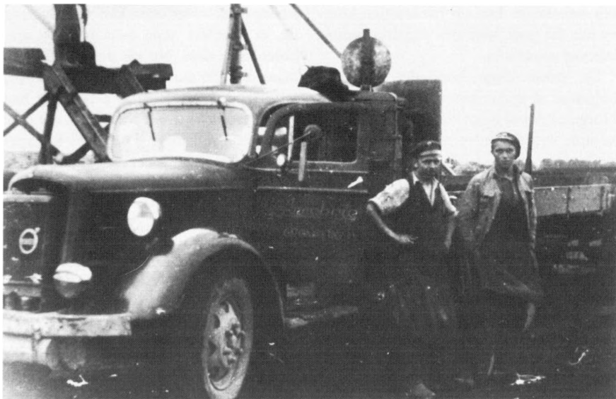
Lastbil med generator, fra G. Anneberg, Grønbjerg, under læsning af brunkul i Abildå-lejet. 1942-1943.
